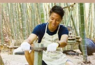
適度な長さに切り出した竹を、「竹割り」と呼ばれる専用の刃物で割る作業。木づちを使ってある程度刃物を食い込ませた後、両手で地面に叩きつけると、竹は見事に均等な幅で一気に割ることができます。
